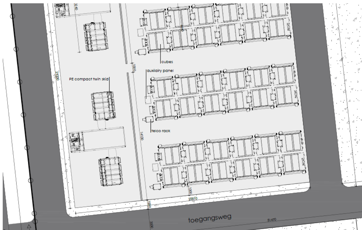
Figuur 2: Overzicht rijen Fluence Cubes en twin-skid powerconversiestations.
